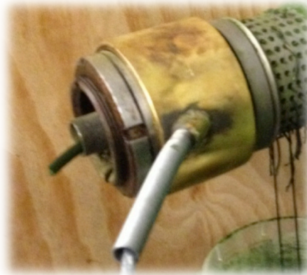
Test di spremitura di microalghe con pressa a vite
